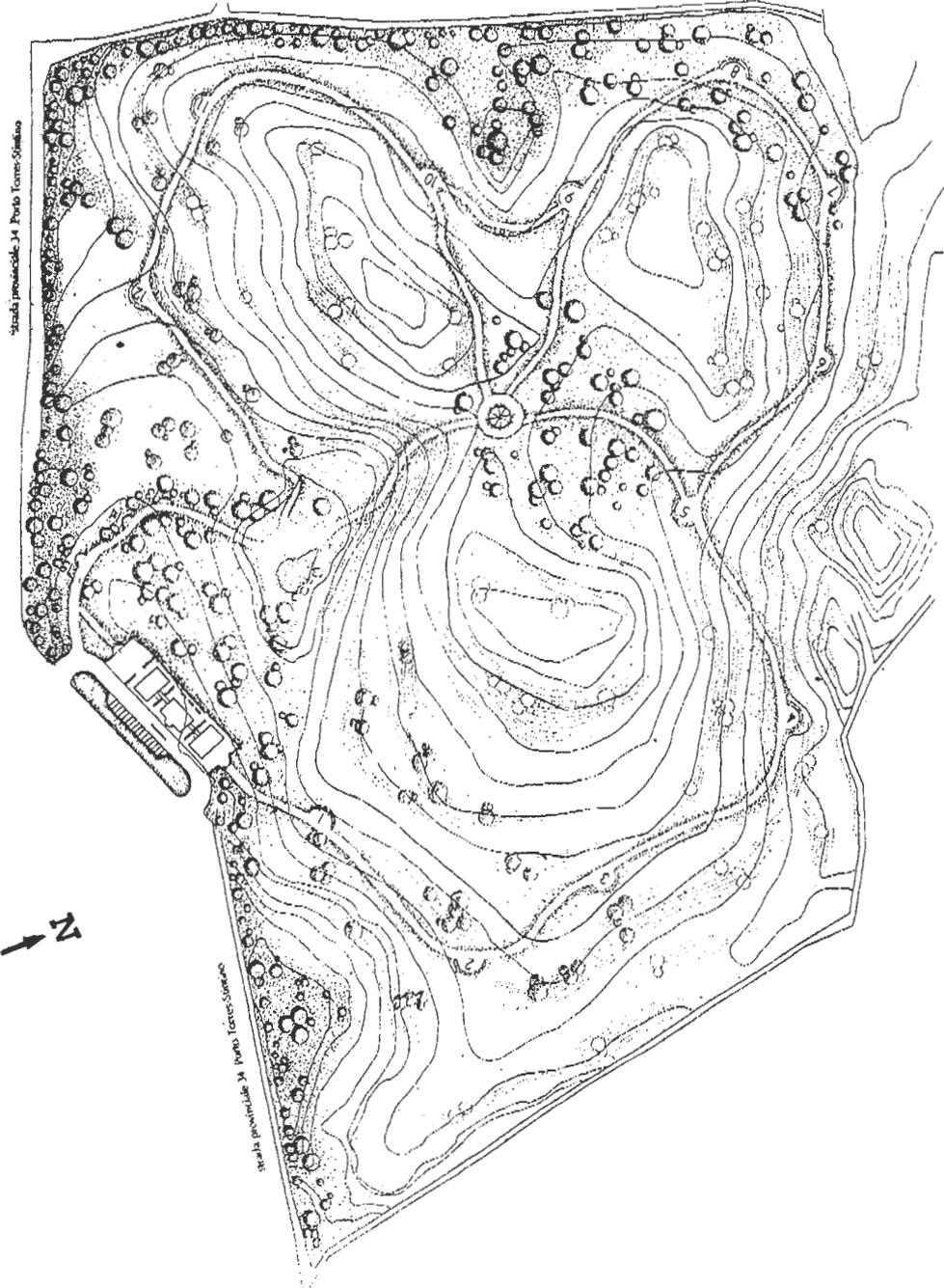
Fig. 6 - Planimetria del progetto di ripristino ambientale del sito di discarica di Scala Erre in scala 1:5000. Sono visibili gli itinerari storico-geologico e geobotanico, i punti di sosta e le strutture museali e di accoglienza.
